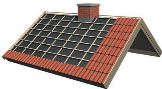
Attēls 16: Betona dakstiņu klāšanas virziens
