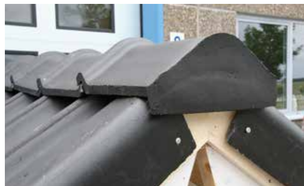
Montagebild 6. Passen Sie die Höhe der Firstlatte so an, dass der First den Universal-Giebel überdecken kann. Schieben Sie den obersten Giebelstein so hoch, dass er vom Firststein überdeckt wird. Hierdurch wird die Überlappung mit dem nächst unteren Giebelstein geringer. Es wäre auch möglich, den Stein mit einer Fuge stumpf gegen die Firstkante stoßen zu lassen. Dazu muß jedoch der jeweils äußere Deckstein ein geringes Gefälle zur Dachfläche hin aufweisen, damit das Regenwasser nicht unter dem Giebelstein an der darunter liegenden Holzkonstruktion entwässert.
