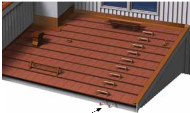
Pildil: redeli kinnituskonksud paigaldatud katusel
