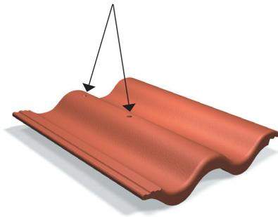
An der Formsteinunterseite wird der verzinkte Metallbügel (1) mit zusätzlicher Traglatteneinhängung montiert und mit der auf der Steinoberseite, auf der Mittelwulst aufliegend, befindlichen Steigtritt-/Bügelaufnahmehalterung (2) zusammengeschaubt. Die dafür notwendige Edelstahlschraube und Mutter liegen der Lieferung bei. Die Aufnahmehalterung besteht aus pulverbeschichtetem Metall.
