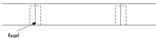
Bild 4: Montage med Carisma nockpanna ändstött, med bygel.
