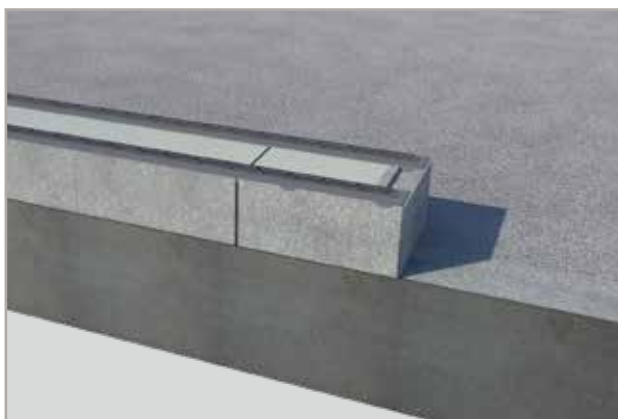
1. Vid användning av bistål ska bruk appliceras på blocket innan armeringen.
