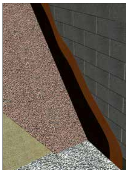
Bild 5.5. Källarvägg med LECA lättklinker
