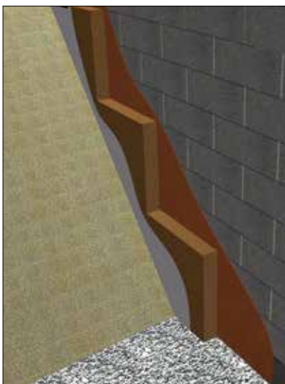
Bild 2.4 Källarvägg med Isodrän
