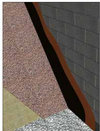
Bild 2.6 Källarvägg med LECA lättklinker
