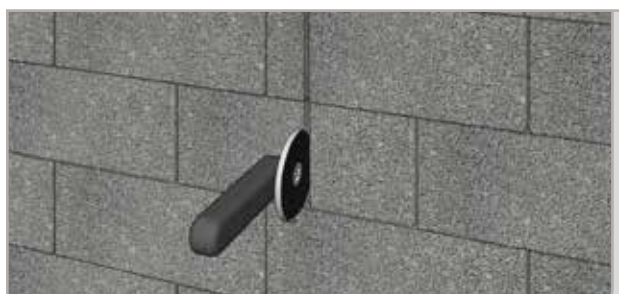
1. Säge ett snitt i väggen med en stenklinga för att bestämma var eventuella sprickor ska hamna.
