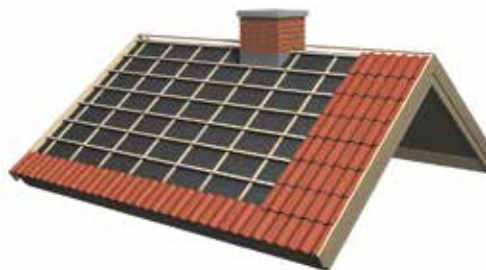
Figur 11. Legg først nedre rad fra høyre til venstre. Fortsett så med en rad helt opp til mønet. Sjekk at steinene ligger i vinkel mot nederste rad. Fortsett med to-tre rader av gangen helt opp. Kontroller at radene ligger rett.
