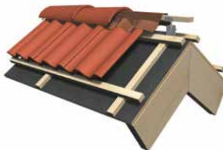
Figur 12. Det er viktig at møne og valmtetningsrullen ikke ligger mot sidene på mønekammen, kun på toppen. Da får du best utlufting. Husk min. 50 mm omlegg ved bruk av møne og valmtetningsrull.
