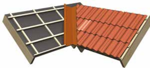
Figur 18. Utførelse av gradrenne.
