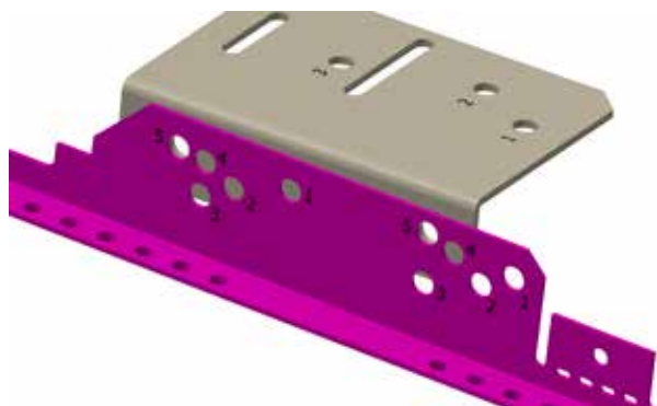
Exempel: Piano hål 5-5 i infästningsenhet mot hål 5-5 i konsolfäste.
