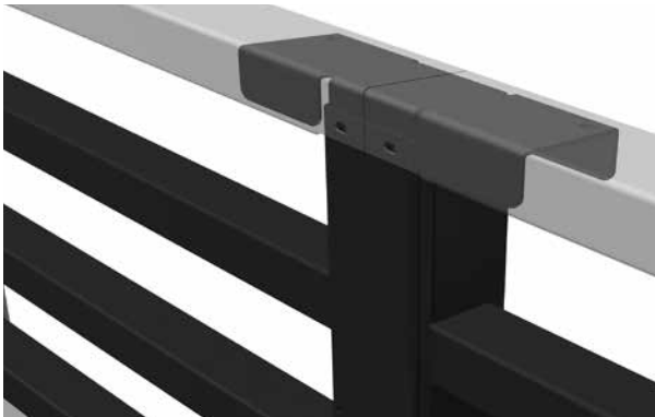
Monteringsbilde 12. Koblingsstykket skal settes ned på innsiden av midtstolpen.
