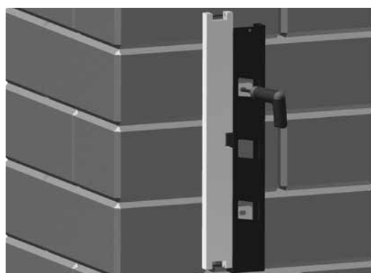
Monteringsbilde 2. Endestolpene plasseres mot kolonne midt på mur, og rettes vertikalt. Mitt i de 2 festeklakkene borres hull Ø6 mm med minst 35 mm dyp.
