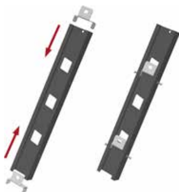
Monteringsbilde 1. Begynn med endestolpene. Festebeslag monteres i endestolpene. Toppen av stolpen har et lite hull i senter, og klakkene på festebeslaget skal peke oppover. Dra beslagene oppover før skruene strammes, slik at det er mulig å justere stolpene senere.
