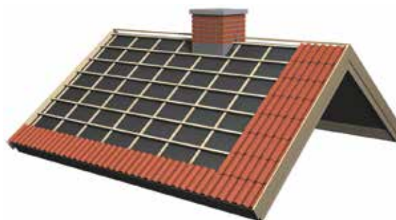
Bild 7. Fortsätt med två till tre rader i taget ända upp. Kontrollera att raderna ligger rakt.
