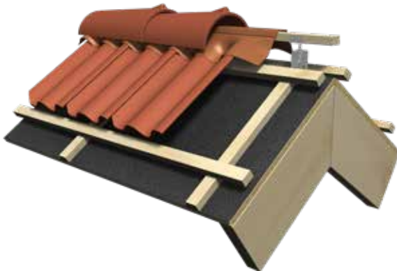
Bild 10. Det är viktigt attnock- och valmtätningssrollen inte ligger mot sidorna på nockplankan, utan endast i ovankant. Då luftas nockplankan ordentligt.
