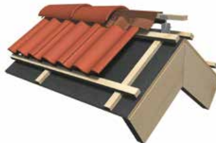
Figur 11. Det er viktig at møne og valmtetningsrullen ikke ligger mot sidene på mønekammen, kun på toppen. Da får du best utlufing. Husk min. 50 mm omlegg ved bruk av møne og valmtetningsrull.
