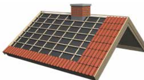
Figur 10. Legg først nedre rad fra høyre til venstre. Fortsett så med en rad helt opp til mønet. Sjekk at steinene ligger i vinkel mot nederste rad. Fortsett med to-tre rader av gangen helt opp. Kontroller at radene ligger rett.
