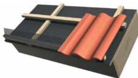
Figur 9. Fuglebåndet monteres på takfotslekten. (Takfotslekten skal være 10 mm høyere enn bærelekt.) Ved bruk av ventilert fuglebånd har dette en byggehøyde på 25 mm.
