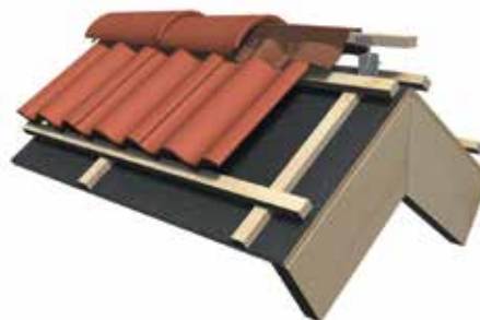
Figur 11. Det er viktig at møne og valmtettingsrullen ikke ligger mot sidene på mønekammen, kun på toppen. Da får du best utlufting. Husk min. 50 mm omlegg ved bruk av møne og valmtettingsrull.
