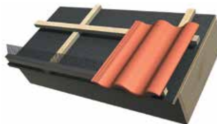
Figur 3. Fuglebåndet monteres på takfotslekten. (Takfotslekten skal være 10 mm høyere enn bærelekten.) Ved bruk av ventilert fuglebånd har dette en byggehøyde på 25 mm.
