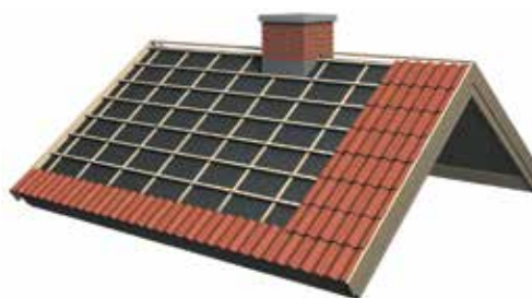
Figur 8. Legg først nedre rad fra høyre til venstre. Fortsett så med en rad helt opp til mønet. Sjekk at steinene ligger i vinkel mot nederste rad. Fortsett med to-tre rader av gangen helt opp. Kontroller at radene ligger rett.
