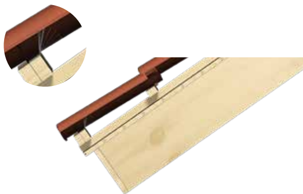
Figur 3. Fuglebåndet den ekstra lekten bak takfotslekten. (Takfotslekten skal være 10 mm høyere enn bærelekten.) Ved bruk av ventilert fuglebånd har dette en byggehøyde på 25 mm.
