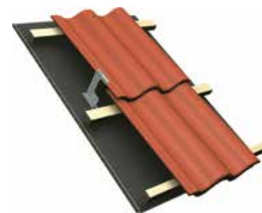
26 pav. Čerpė laikiklis kalamas į grebėstą, tvirtai „surakina“ viršutinę ir apatinę čerpes.
