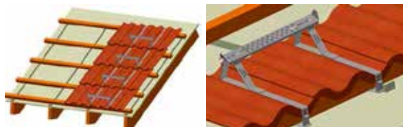
33 pav. Stogo kopetėlės montuojamos ant to paties grebėsto kaip ir stogo čerpės, užkabinant ją už grebėsto.
