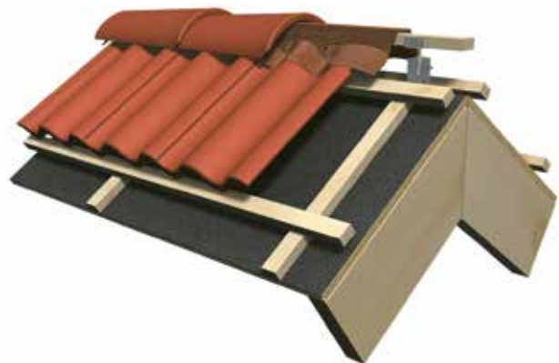
13 pav. Kraigo čerpės turi pasidėti ant medinio kraigo tašelio ir tuo pačiu remtis į eilines čerpes.
