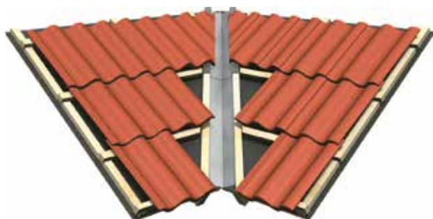
29 pav. Aliuminio stoglatakio įrengimui naudokite papildomus atraminius tašelius arba lentų paklotą.
