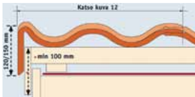
Kuva 11. Benders päätytiilillä tiivis päätyrästös. Kun käytät päätytiiliä huomioi lappeen mitoitus. Katso kuva 12.
