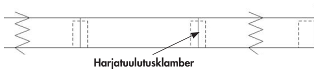
Joonis 7. Carisma otsakuti ühendatud harjakivid, harjatuulutusklambriga. Enimlevinud lahendus horisontaalharja puhul.
