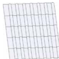
Kein Dachstein wird befestigt.
