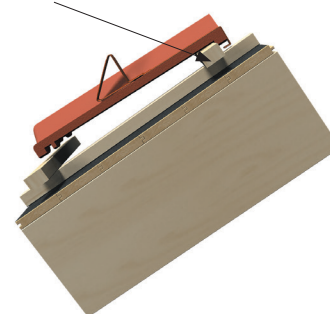
Fixierung in die Dachlatte
