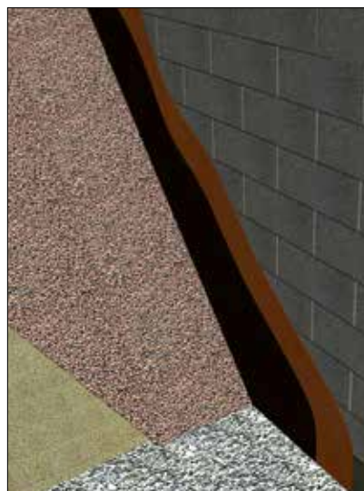
Bild 2.6 Källarvägg med LECA lättklinker
