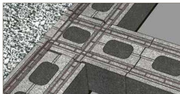
Bild 3.3 Armering av stödvägg.
