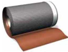
Vegg og takavslutningsrull For tetting i overgang mellom vegg og tak. Rullen er kantklistret på en side. 300 mm x 5 meter. Leveres i svart, teglrød og lysgrå.
