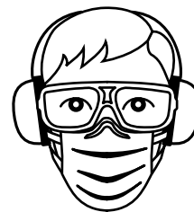
Bild 2. OBS! Vid kapning av sten ska skyddsglasögon, hörselskydd och andninskydd användas.
