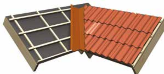
Bild 15. Utförande av rännedal Rännedalar är känsliga delar av takkonstruktionen och skall utföras omsorgsfullt. Pannorna skall kapas i raka linjer och spolas rena från damm omgäende.
