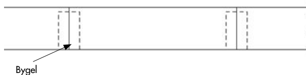
Bild 4: Montage med Carisma nockpanna ändstött, med bygel.
